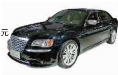
扎实。动力方面,新车搭载的同样是3.6升V6发动机,最大功率达到了210kW,峰值扭矩为340Nm。传动系统方面,与之匹配的是一台8速手自一体变速箱。
