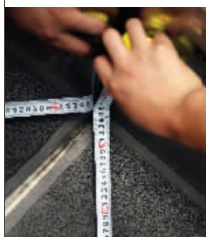
电梯轿底对角线约2.05米
