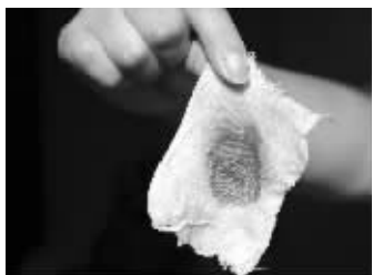
这块纱布是村民自制放在水龙头上过滤杂质的,村民说用一天就变黑,每天都要换
