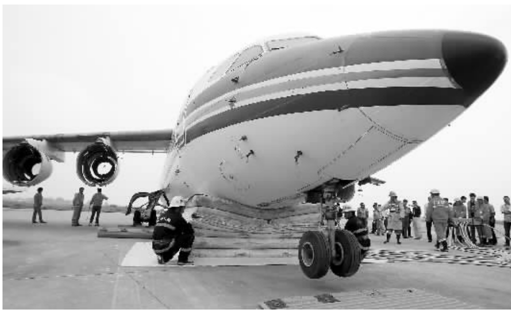
顶升气囊将飞机顶起来 现代快报记者 顾炜 摄
