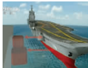
图一:浮箱缓冲示意图
