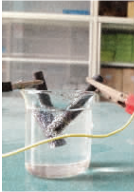
用铂电极和石墨电极电解，自来水和纯净水都没有变化
