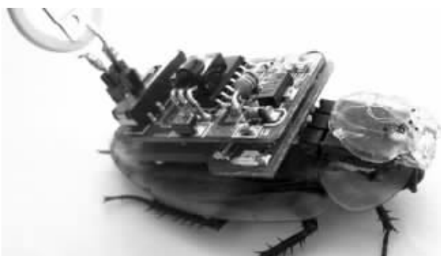
美国Backyard Brains公司研制的“RoboRoach”设备能让普通人远程控制蟑螂的行动
