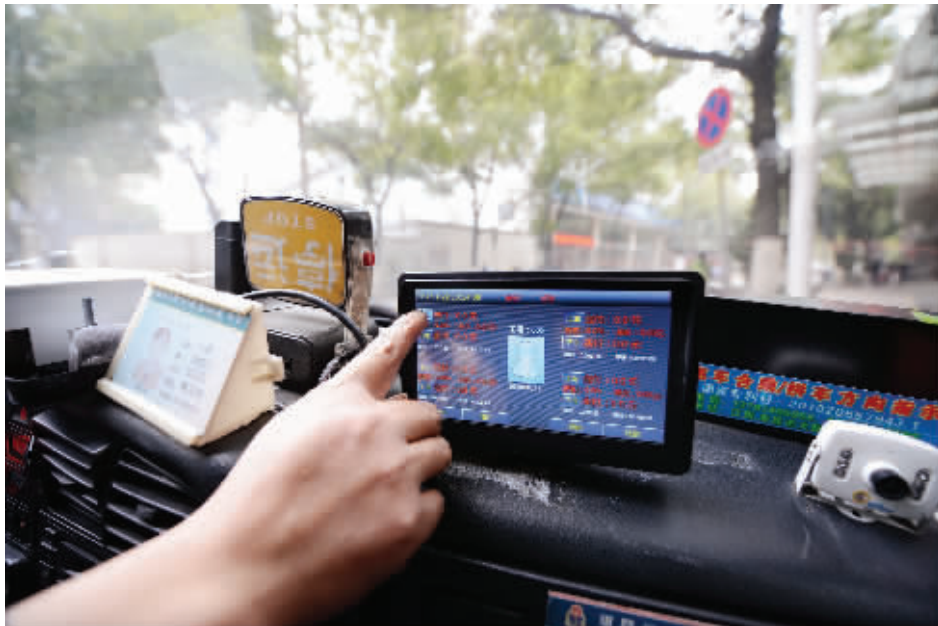
南昌试点出租车上的合乘计价器,可以为四位不同目的地的乘客分别计价并打出发票
