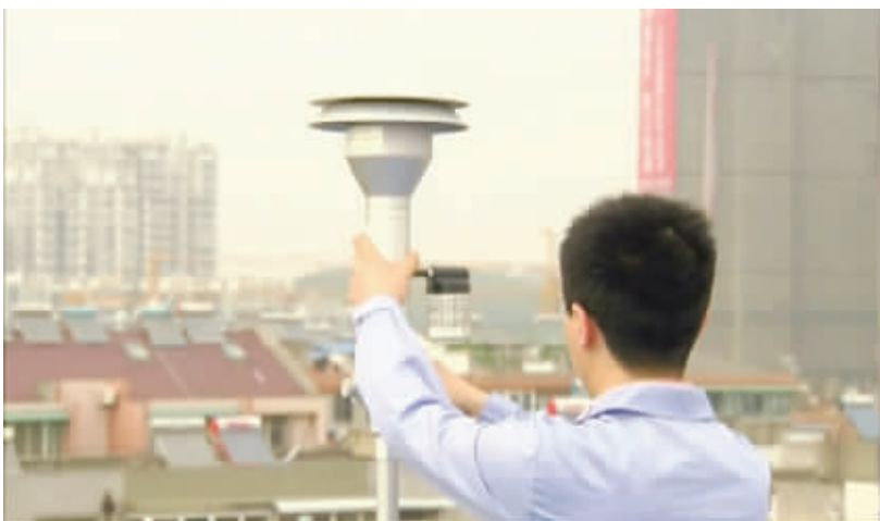
环境监测人员正在检测位于室外的PM2.5监测仪器采样头 苏州市环保局供图
