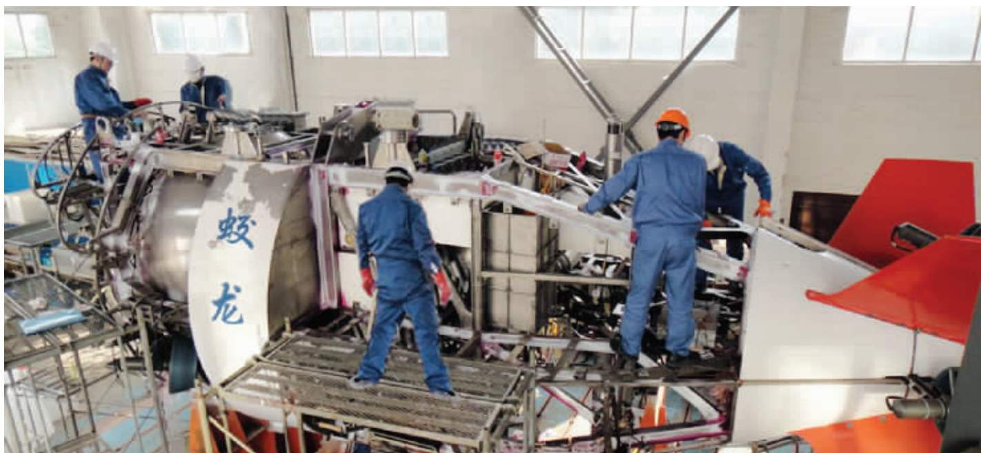
江苏特检无锡分院的技术人员在为7000米深潜归来的“蛟龙号”全面体检 本版图片由特检院提供
