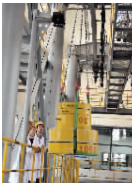
工作人员使用电动葫芦试验台开展型式试验
