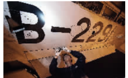
检修人员对襟翼进行保养
