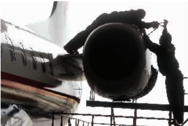
两名检修人员对飞机发动机燃油喷嘴进行更换
