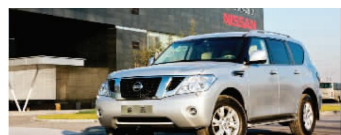
尺寸硬派SUV。途乐搭载5.6L V8发动机,其最大功率高达293kW,最大扭矩高达560N·m,与之相配的是一款全新的7挡手自一体变速器,使得途乐在低速状况下越野性能更强劲,在高速行驶中油耗更低。途乐车身结构为非承载式车身,采用了前置四驱的驱动方式,前后悬架均为双叉臂独立悬挂,在保留原有越野性能的同时,运动性能也得到了大幅度提升。
