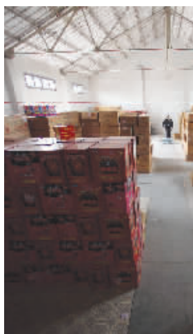
仓库墙上有道红线,要求堆放烟花爆竹不能超过2.5米
