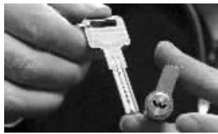
“A级锁级别最低,防盗的功能也最弱。”韩智宝说着向记者展示了两种较为普遍的A级锁,一种A级锁的钥匙是一字形的,两面都有凹槽和小圆点;另一种A级锁则是月牙形的,在凹陷处有锯齿和凹槽。
