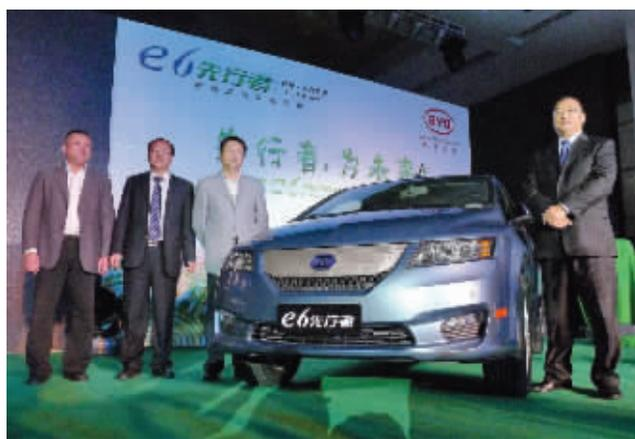
续驶能力一直是制约电动车发展的重要因素,目前全球多数纯电动车的续驶里程集中在80-160公里区间,仅能小部分满足日常代步需求。而比亚迪依托自身“电池大王”的优势,以自主研发、高安全、储电多、功率大的铁电池作为动力电池,使e6先行者一次充电续驶里程最长达到300公里,列世界第一,是名副其实的“先行者”。
