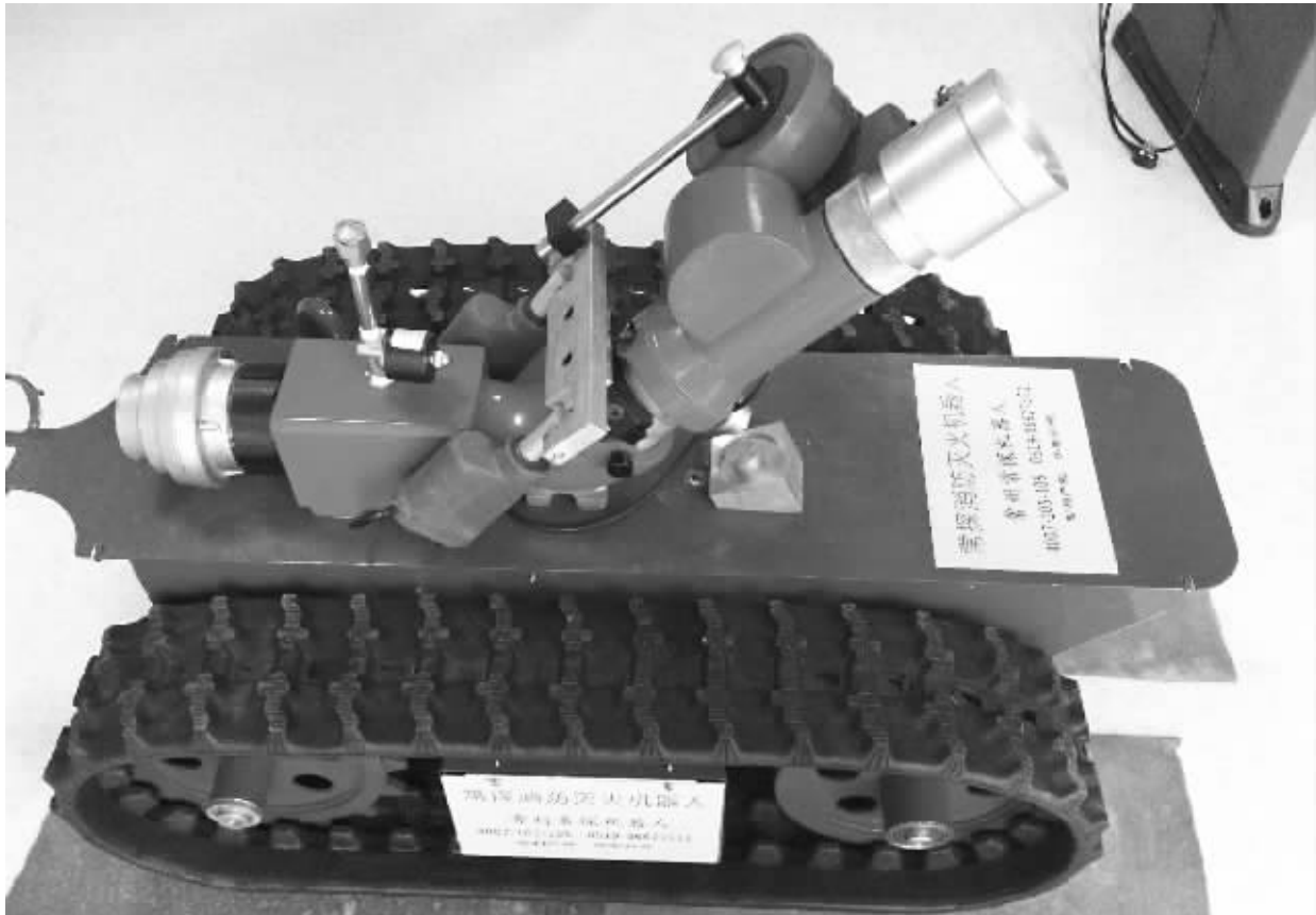
消防机器人像个迷你坦克,水柱能喷射30-100米
