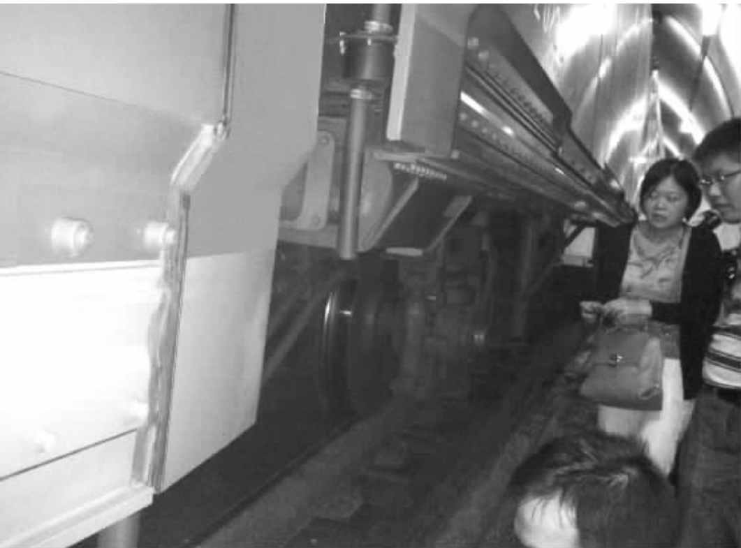
轨道拱起导致列车两节车厢上下错位
