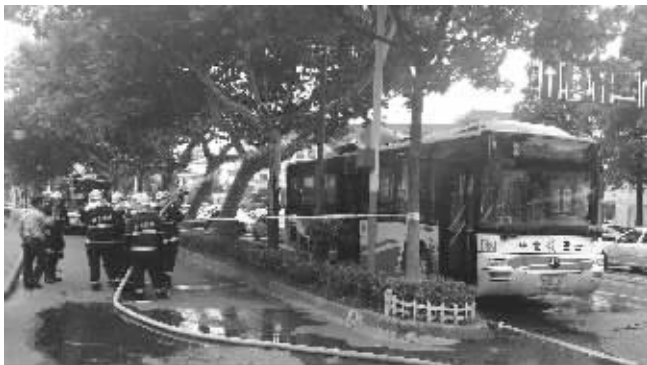
消防队员正在喷水稀释公交车顶部泄漏的天然气
