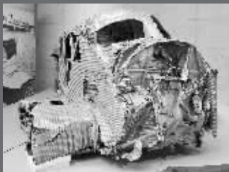
F-13坠落后的残骸,由此可以看到其波纹铝蒙皮,这种材料很坚固,具备极佳的“抗坠落损毁性”
