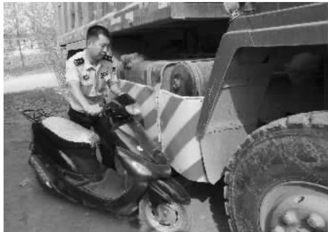
民警在试验新型防护装置,看能不能有效防止伤人事故 叶建华 摄
