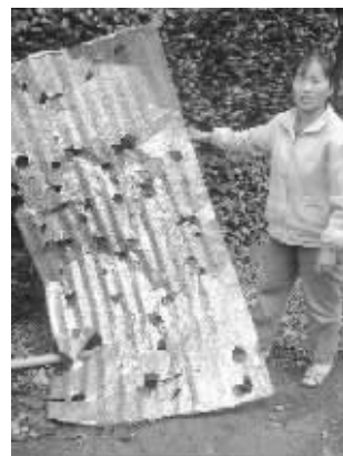
被冰雹打破的铁皮瓦
