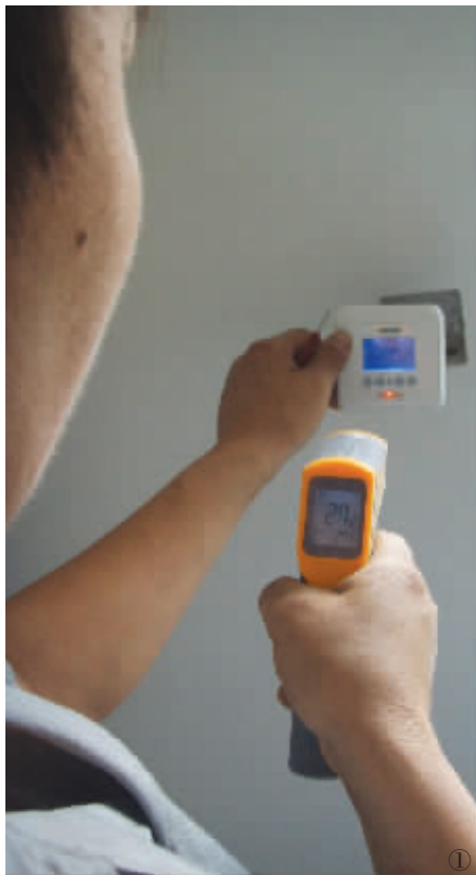
图1为工作人员在测试温度。墙上的温控器是调控地板温度的,而工作人员手中的温度枪则是核对温度。温控器调节的是27℃,温度枪核对出的数据也是27℃。尚兰格具有优良的制暖效果,温度可智能调节,有人在可以迅速发热,没人在也不耗能。
