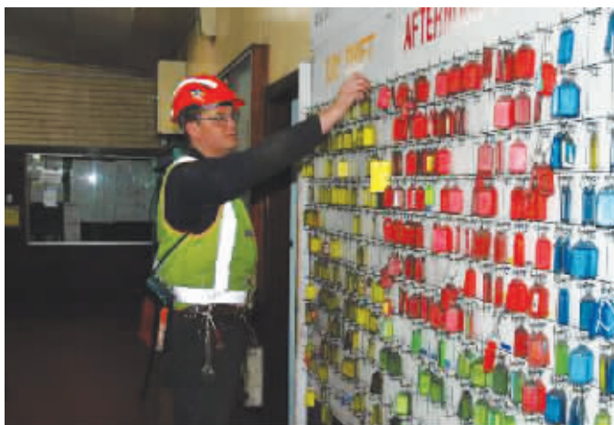
一名矿工在澳大利亚阿平煤矿的井下挂牌处挂牌。阿平煤矿是澳大利亚公认的瓦斯高渗矿,因此它的生产措施格外严格。
