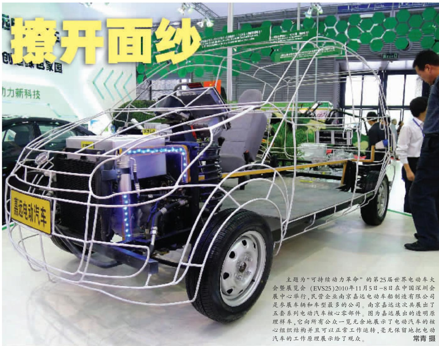
主题为“可持续动力革命”的第25届世界电动车大会暨展览会(EVS25)2010年11月5日-8日在中国深圳会展中心举行,民营企业南京嘉远电动车船制造有限公司是参展车辆和车型最多的公司。南京嘉远这次共展出了五套系列电动汽车核心零部件。图为嘉远展出的透明原理样车,它向所有公众一览无余地展示了电动汽车的核心组织结构并且可以正常工作运转,毫无保留地把电动汽车的工作原理展示给了观众。
