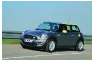
宝马MINI E中国实路测试项目已正式进入实施阶段,日前,宝马集团已经在MINI中国的官方网站(www.minichina.com.cn)上启动了针对首批私人用户的招募。本项目使用的MINI E纯电动车是宝马集团为开发可持续的未来城市交通解决方案所设立的project i的首项成果。以当前MINI车型为基础开发并采用双座设计,MINI E装备一台输出功率高达150千瓦(204马力)的电机,由一组高性能可充电的35千瓦时锂离子电池提供电能,实际城市路况下的续航里程可达到140~170公里,日常电费支出仅相当于可比条件下用油成本的15%~20%。
