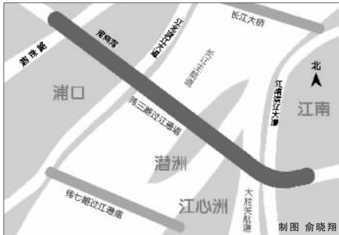
在可行性报告中,双向双层 8 车道的 X 形隧道由左、右两股通道组成,左线通道暂命名为扬子江隧道,右线通道暂命名为定淮门隧道。
