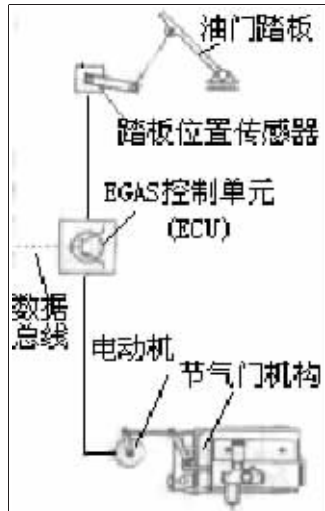
电子油门结构示意图
