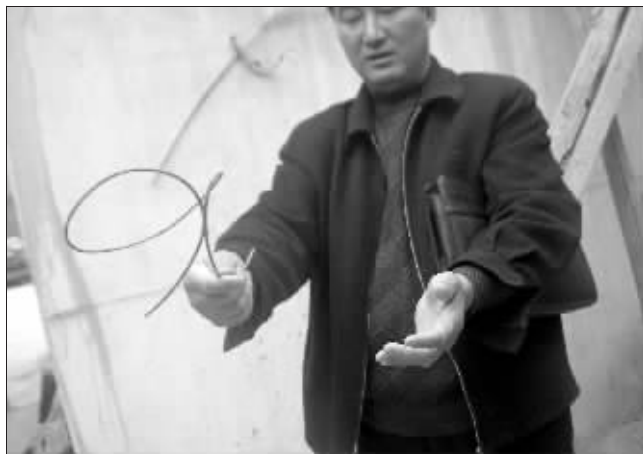
房梁里的“钢筋”可以弯成这样
