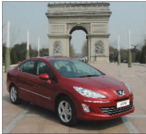
虑和研究了中国消费者的需求。标致汽车成功首创的半高结构,为408这款三厢轿车提供了最优的驾乘空间、最大的视野和最佳的车内光照度。外部尺寸在外形尺寸方面,408在前所未有的乘用空间和高安全性之间找到了最好的平衡。408车身长度高达4680 mm,这样长的车身使得内部可用空间变大,这是因为:轴距的长度为2710 mm,这个轴距主要有利于后排乘客空间的增大,前悬为938 mm,后悬为1032 mm,这样就可以得到一个大容量的行李箱车宽为1815 mm,这个车宽可以提供优异的侧面被动安全性,以及一流的驾乘空间。
