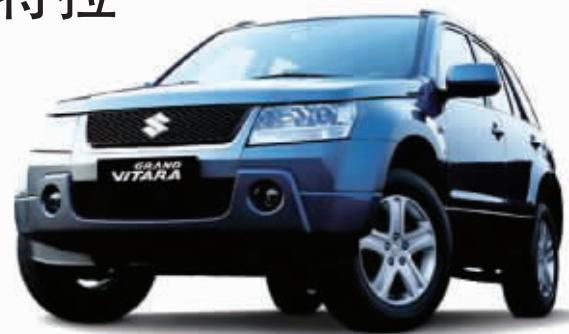
承载式车身上加入了“梯形车架结构”之后，底盘刚性比轿车化的承载式车身更为出色；4缸直列发动机纵置在车内，不仅实现了比横置更高的传动效率，而且也避免了对车身重心的影响。
