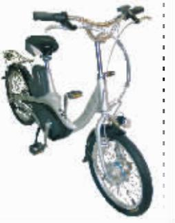
绿源“24小时金牌服务”上门专用车,拥有外观设计、防侧翻结构、前后支架锁定装置等多项专利。大装载承重、停车方便、不需要各种支撑,驾驶方便、安全可靠。配置上,采用无刷桥式差速高速电机,启动快、动力强,平稳安全,轻松转弯,续航里程在60公里以上。
