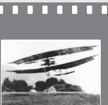
曾于小营机场起降的“寇蒂斯”飞机,年式1911年,乘员1人,机高2.3公尺,净重700磅,时速80公里
