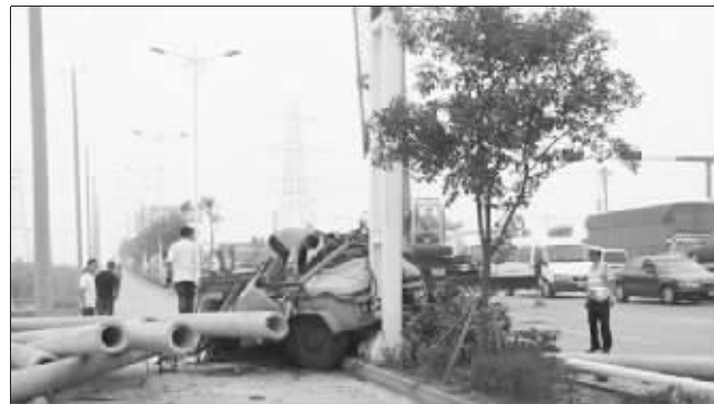
车上的电线杆将驾驶室削平
