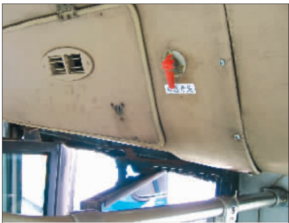
除使用安全锤敲碎车窗玻璃,乘客还可用红色应急开关开门
