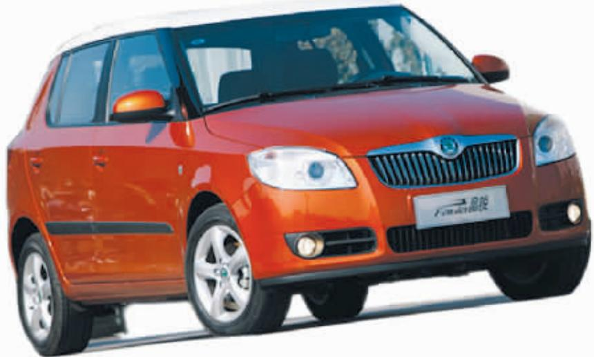
秉持全方位安全车身的设计理念,Fabia晶锐的工程师不仅从力学及人机工程学研究的角度充分利用吸能原理,设置较充裕的缓冲区最大限度地吸收碰撞能量,同时又对车身的关键部位进行特别加强,尤其是A、B柱更采用了同级别的车型极其罕见且一般在航空航天领域采用的热成型工艺,Fabia晶锐的这种设计充分确保了整车的超高强度,令这些原本在车身结构上相对薄弱的部位变得坚不可摧。
