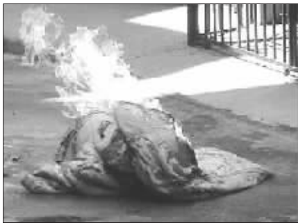
干棉被裹不住喷火的煤气罐
