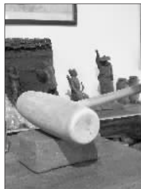
紫砂泥粉和水后,就用这样的木槌反复敲击、碾压
