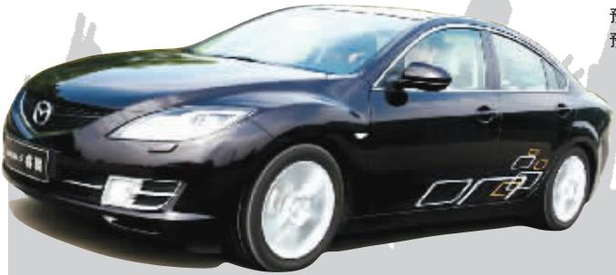
**车型简介:**Mazda6睿翼的开发理念是“进化的ZOOM-ZOOM”(ZOOM-ZOOM Evolution),在安全性、环保、动力等各方面,都达到甚至超越了全球B级车中的最高水平,代表了马自达品牌的终极追求方向,是一款名副其实的“明日之车”,车体造型比目前在售的加长加大,竞争对手瞄准了强劲的雅阁、凯美瑞等,与现有的马自达6形成两代同堂的局面。睿翼全新优化的底盘套件和2.5升发动机令驾驶更有乐趣。翼的最大输出功率可达124kW/6000rpm,在4000转时即可达成226N·m的最大扭矩,进一步提升其驾驶乐趣。
