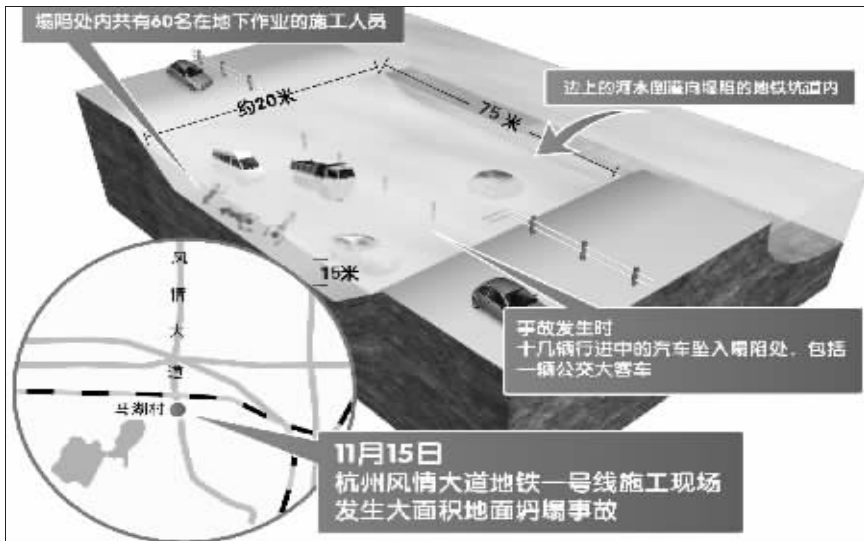
杭州地铁工地发生路面坍塌示意图 CFP
