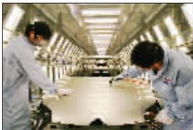
压生产的送料精度达到0.1毫米，在国内居领先地位。汽车覆盖件测量采用美国ROCKWESS数据采集系统和CMM三坐标柔性化测量系统。而在冲压、焊装、油漆和总装四个环节都以无可挑剔的设备和技术达到了国际先进水平，这也是凯旋五星品质的最有力保障。
