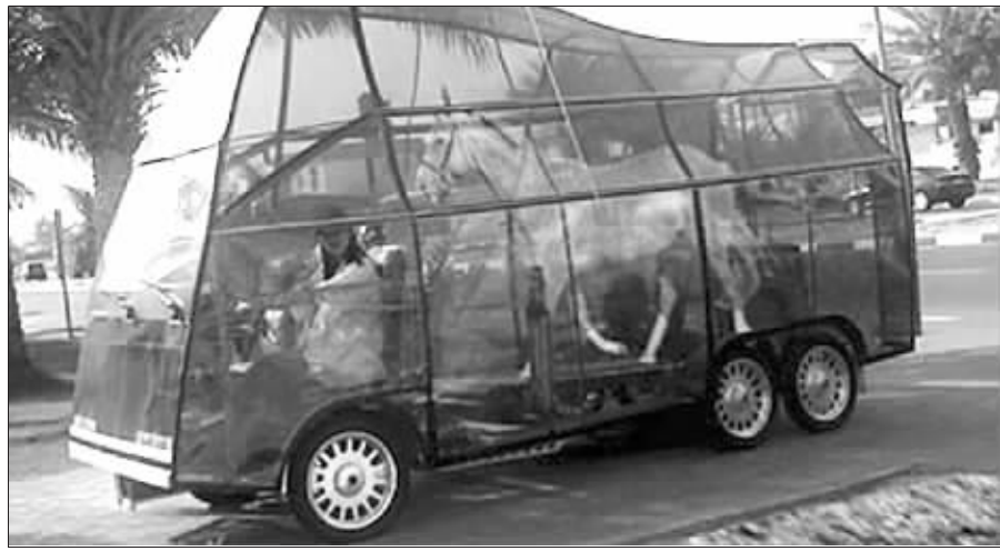
这是一辆概念车,其特点是,以一匹马来带动发动机从而获得汽车运行的动力。概念车如小客车大小,乘客坐在前排,而马站在车尾的传送带上。和汽车一样,这款车也考虑到“废气”处理问题,该车内部有特别装置对马排放的“废气”进行回收。
