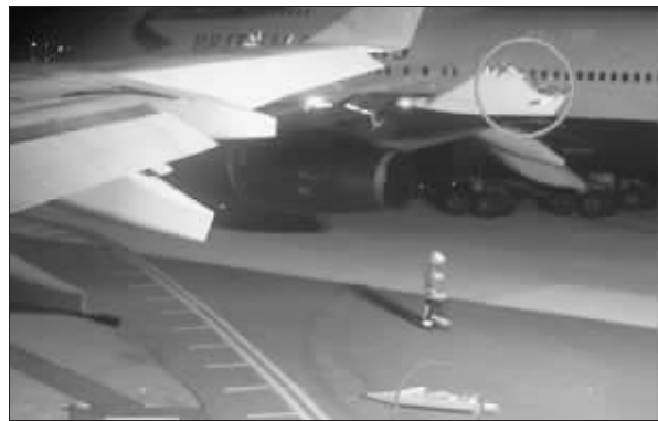
英国航空公司的 747 客机的左侧机翼尖被撞受损,而地上掉落的就是斯里兰卡航空公司 A340 空客的机翼尖。
