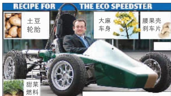
英国的研究者们日前打造出了一辆英国最环保的赛车——“环保一号”,它的轮胎是由土豆材料制成,刹车垫是用腰果壳制成,车身则用大麻纤维制成,而它的燃料则是用发酵的小麦和甜菜加工制成的。但让人惊讶的是,这种超环保赛车的速度却可以达每小时150英里!
