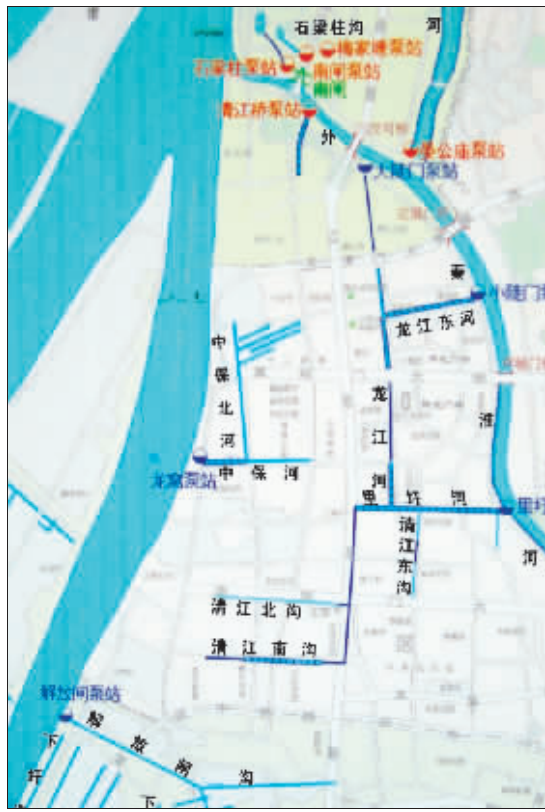
图为“河西北部地区的污水收集系统和管道完善”工程示意图。该工程将利用大陡门、小陡门、里圩泵站引外秦淮河水,冲洗中保河,更重要的是打通龙江河河道,形成外秦淮河—龙江河—中保河—夹江的水循环,让该区域的死水“活”起来。制图 刘子照
