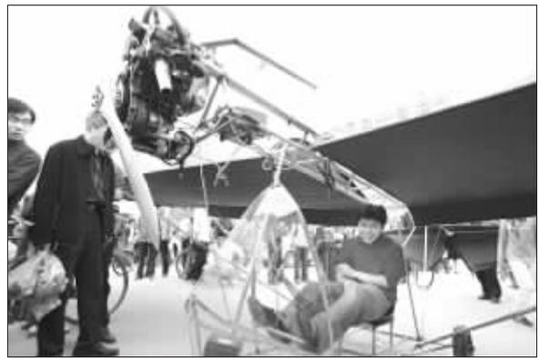
据新华社武汉4月13日专电(记者 李鸣翔)翼展8.7米、长7.5米、耗资1.5万元、总重量100公斤、不锈钢钢管飞机骨架、木制螺旋桨、布制机翼……这就是湖北美术学院工业设计系大四学生黄立通过两年设计、一个月制作出来的超轻型飞机。
